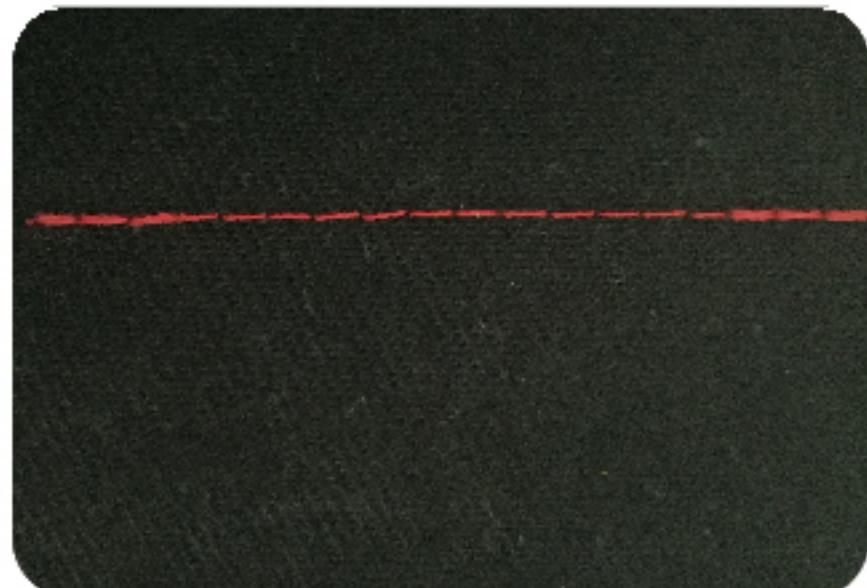
② 前后密针缝：缝制起始/终止端锁小针距线迹,有效缩短留在缝料上的线头长度,防止线头散出.
