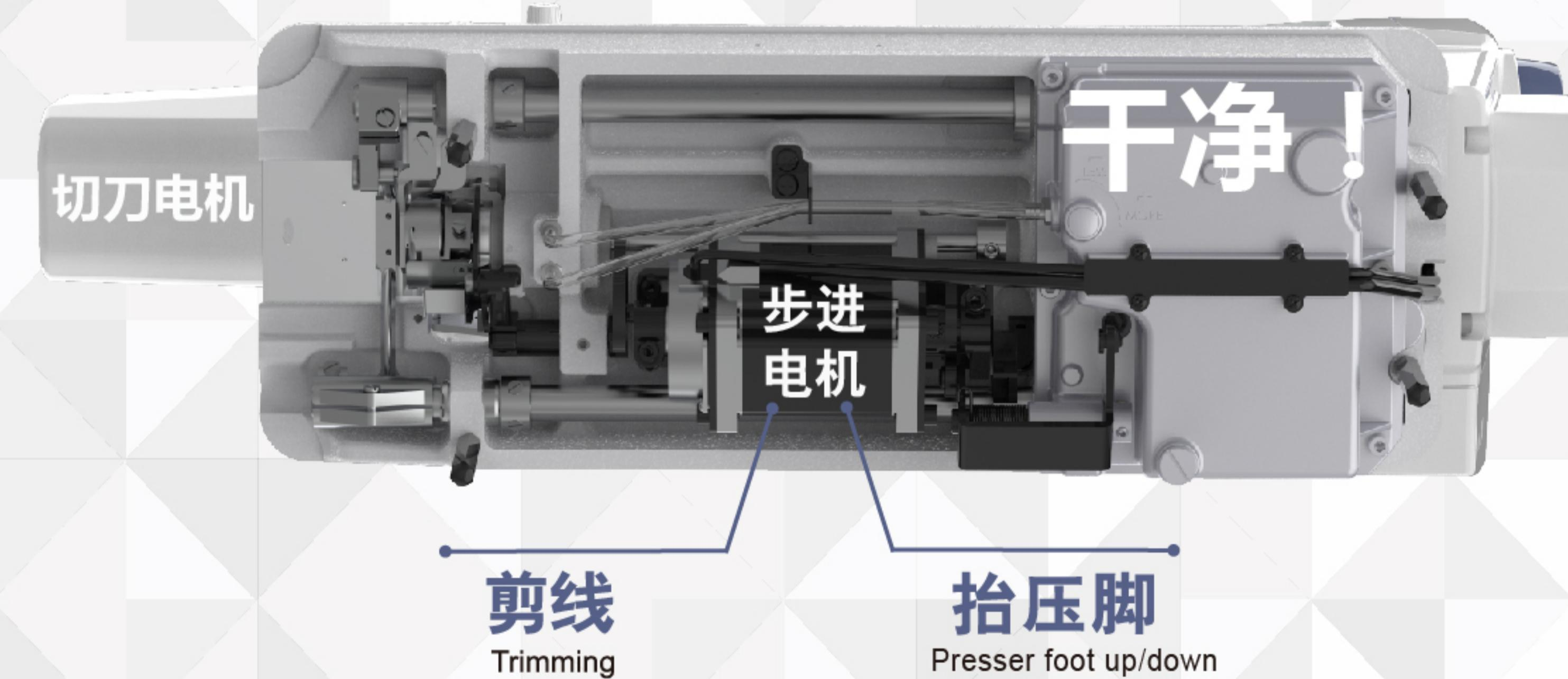
可靠的切刀结构:采用步进马达驱动,结构简单,切线稳定声音轻,方便维护。
