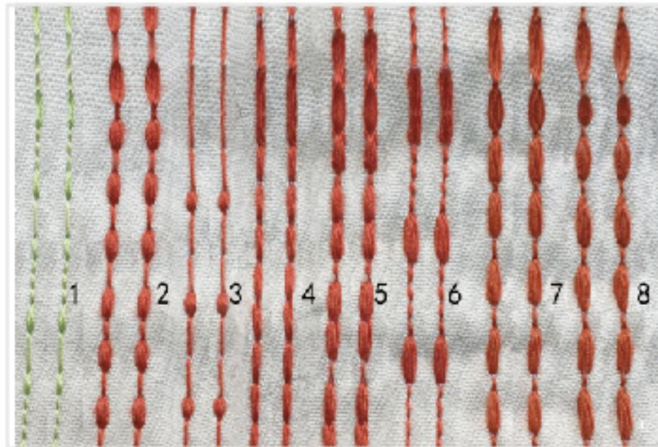
① 花样缝：由于步进马达控制,1952D可以自己设定产生8种不同线迹,精准的送料行程,可以实现针迹重合的加固缝.
